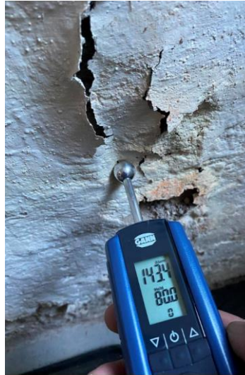
Fugtmåling i væg - 143,4 %
